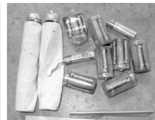
危険な異物が混入している (スプレー缶、電池、カミソリ)
