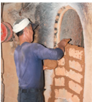
←原木を炭焼き窯に並べた後は、焚き 口を残して、土とレンガを使って入 口をふさいでいく。
