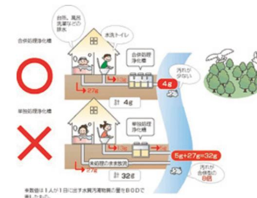
「合併処理浄化槽」は、家庭から出る「生活排水(=し尿と台所、お風呂、洗濯等の雑排水を合わせたもの)」のすべてを浄化できるスグレものです。し尿処理だけに対応した「単独処理浄化槽」では、台所、お風呂、洗濯等の排水をそのまま河川に流してしまい、自然に大きな負担をかけてしまいます。環境にやさしい「合併処理浄化槽」への転換がいま強く求められています。
