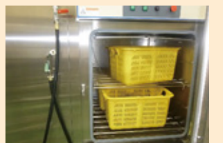
▲真空冷却機に野菜を入れた様子
