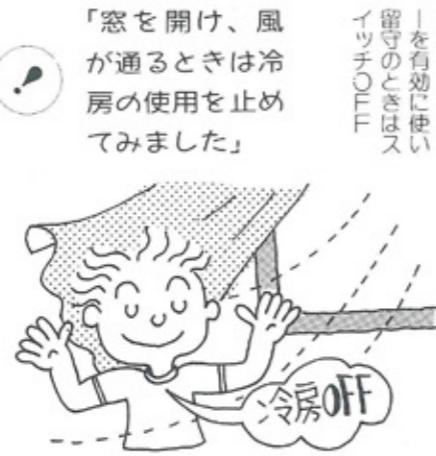
「エアコン」効率運転が可能なインバータ方式などにより年々省エネ化が進むエアコンですが、使い方次第でさらによい効率運転が可能になります。室内温度は適度に(夏は28度が目安)、扇風機を併用し冷気を循環させる/消費電力の少ないドライ機能を活用する/こまめにフィルターを掃除/タイマーを有効に使いこなす/窓の留守のときは扇風機を停止するなどの方法で省エネになります。
